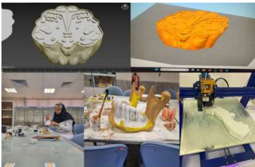
شکل ۲. تصاویر مربوط به مراحل تولید مکامولاژها (طراحی، پرینت، رنگ آمیزی).
